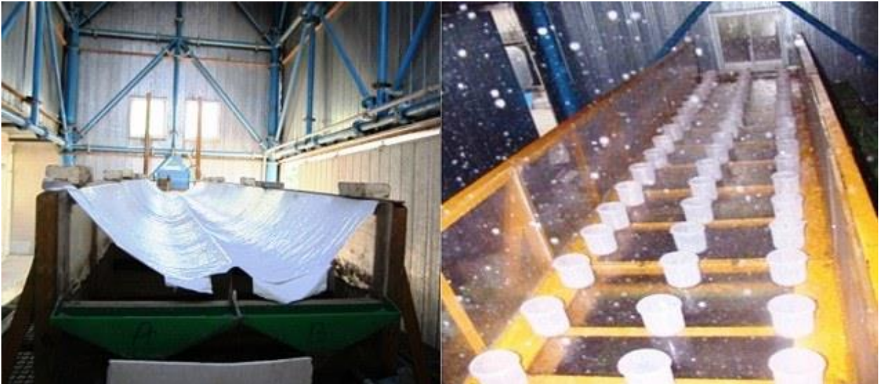
شکل ۲- چیدمان ظروف (الف) و پوشش روی سطح فلوم (ب) برای اندازه گیری شدت متوسط بارش
